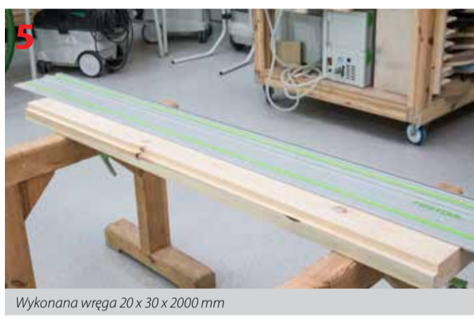
Końcowa faza operacji frezowania wpustu w balu drewnianym
