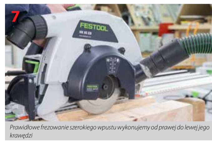
Końcowa faza operacji frezowania wręgi
