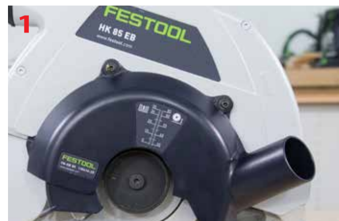
Tabliczka z czytelną informacją o prawidłowym ustawianiu głębokości frezowania w pilarkę HK 85 znajduje się na górnej osłonie frezu
