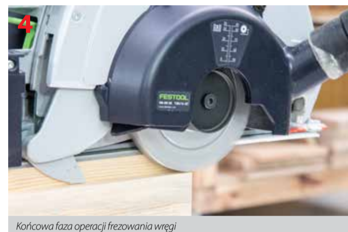
Tabliczka z czytelną informacją o prawidłowym ustawianiu głębokości frezowania w pilarkę HK 85 znajduje się na górnej osłonie frezu
