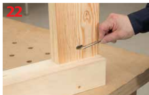
Wykonane połączenie nogi i oskrzyni
