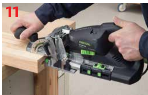
Frezowanie czoła elementu oskrzyni
