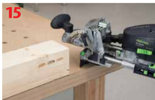
Wykonane otwory w nodze
