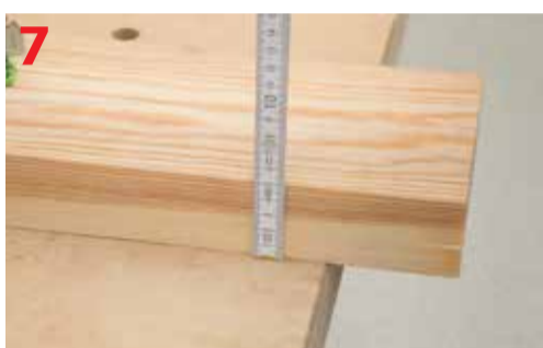
Element oskrzyni ma grubość 50 mm
