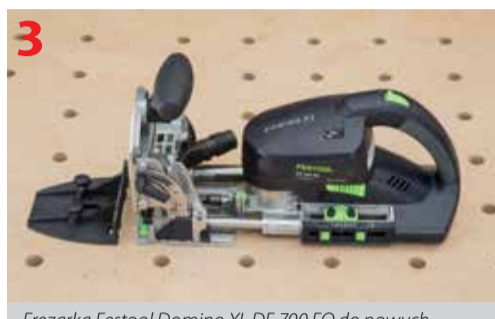
Frezarka Festool Domino XL DF 700 EQ do nowych rozłączalnych łączników Domino
