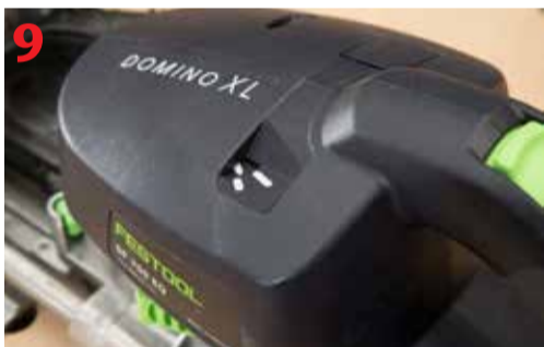
Ustawienie szerokości gniazda frezowanego na 27,5 mm
