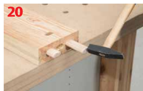
Montaż łączników Domino
