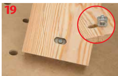
Osadzona kotwa poprzeczna w oskrzyni
