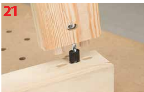
Skrócenie oskrzyni z nogą za pomocą klucza i zaślepienie połączenia
