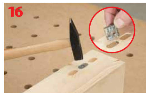
Montaż kotwy rozprężnej
