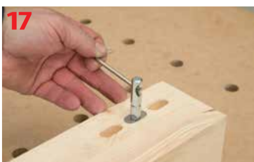
Montaż sworznia kotwiącego w kotwę rozprężną
