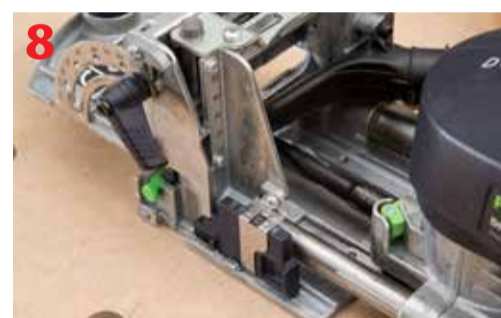
Ustawienie stolika frezarki do grubości elementu
