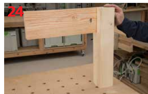
Wykonane połączenie nogi i oskrzyni
