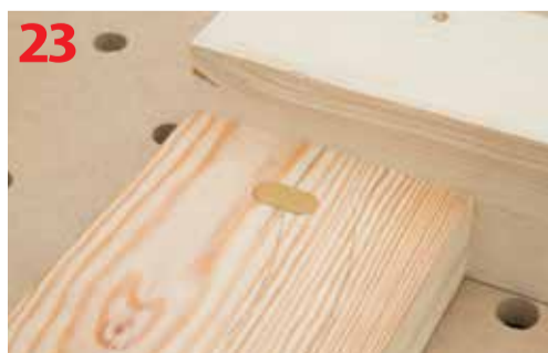
Wykonane połączenie nogi i oskrzyni
