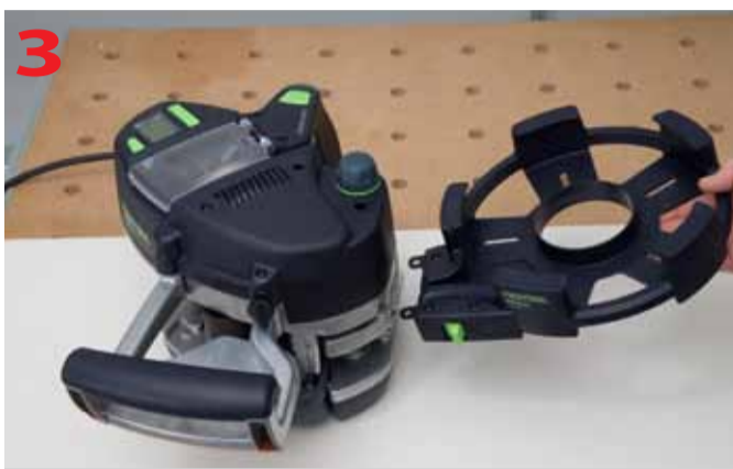
Montaż zasobnika do okleiniarki
