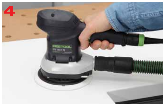
Od granulacji P220 używamy szlifiereki mimośrodowej ETS 150/3 EQ
