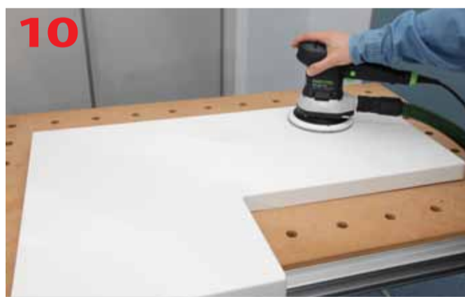
Szlifowanie wykańczające powierzchnię blatu na półmat
