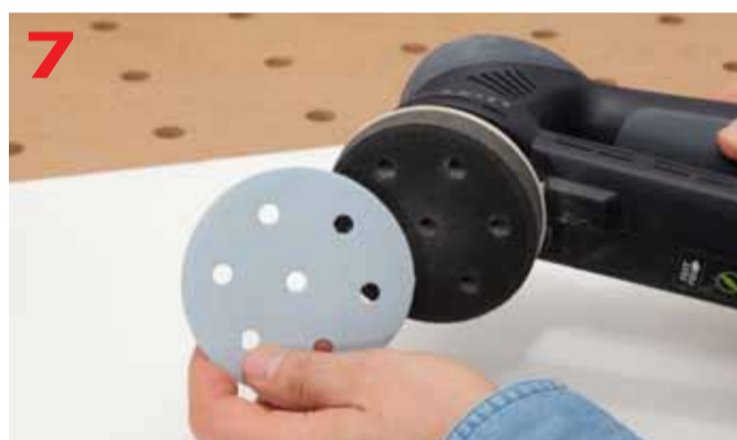
Papier ścierny mocujemy na przekładce
