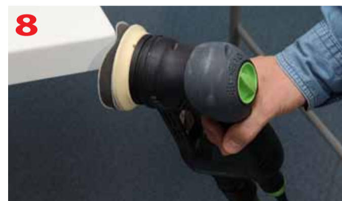
Szlifowanie zaokrąglonego naroża zewnętrznego
