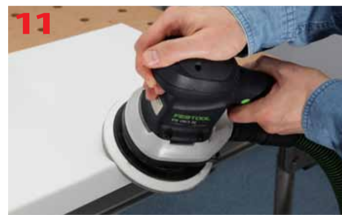
Szlifowanie wykańczające zaokrąglonej krawędzi
