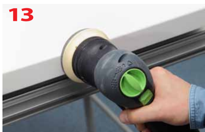
Szlifowanie wykańczające wąskiej krawędzi blatu
