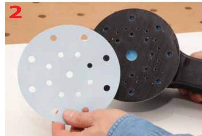
Szlifowanie rozpoczynamy, używając materiału ściernego Granat
