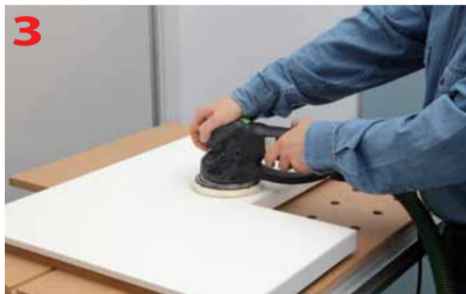
Płaszczyznę blatu szlifujemy szlifierką przekładniową ROTEX RO 150 FEQ
