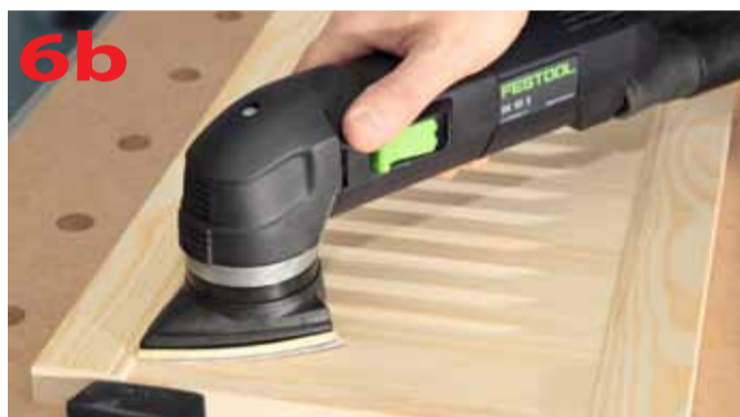
Szlifierka DELTEX ze stopą trójkątną podczas szlifowania lameli i wąskich płaszczyzn.
