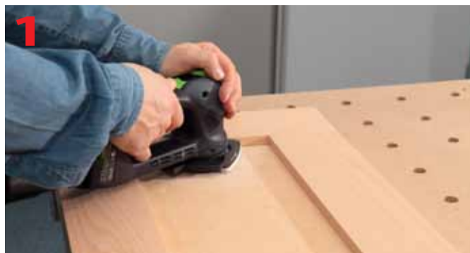
Szlifowanie płyciny przy ramiaku za pomocą szlifierki RO 90 DX FEQ ze stopą trójkątną.
