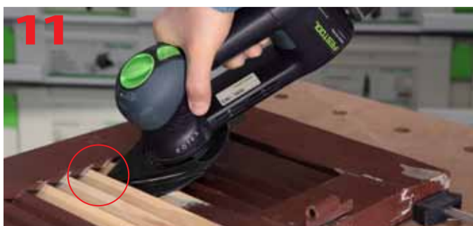
Dokładne szlifowanie lameli okiennicy zewnętrznej za pomocą ROTEX RO 90 DX FEQ ze stopą wydłużoną
