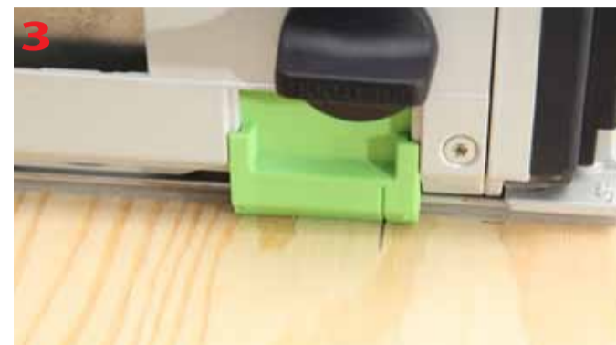
Oznaczenie na wkładce zabezpieczenia przeciwpryskowego wskazuje koniec linii cięcia
