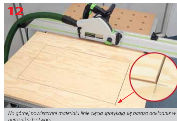
Pilarkę prowadzimy po szynie FS/2 do przedniego ogranicznika
