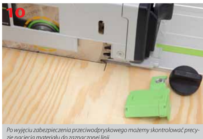
Po ustawieniu pilarki w odpowiedniej pozycji na szynie FS/2 blokujemy zabezpieczenie FS-RSP
