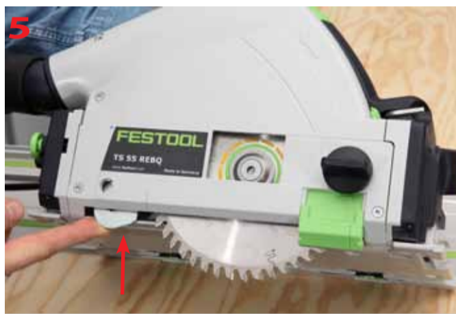
Klin prowadzący pod naciskiem unosi się i chowa w obudowie
