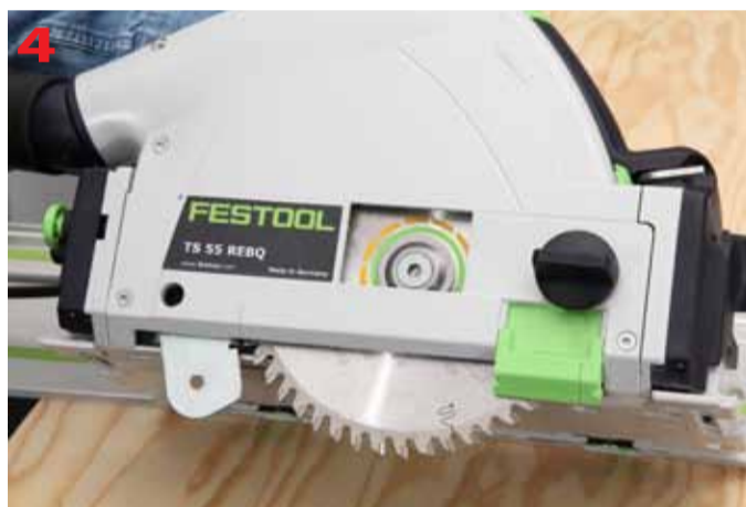
Za tarczą tnącą zamocowany jest klin prowadzący
