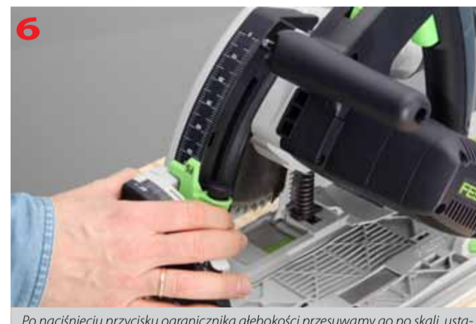
Po naciśnięciu przycisku ogranicznika głębokości przesuwamy go po skali, ustawiając maksymalną głębokość cięcia
