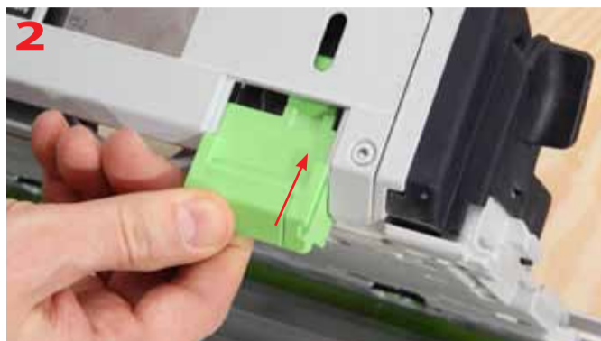
W miejsce okienka kontrolnego możemy wsunąć zabezpieczenie przeciwpryskowe
