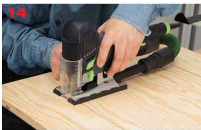
Docinanie narożników otworu możemy wykonać wyrzynarką
