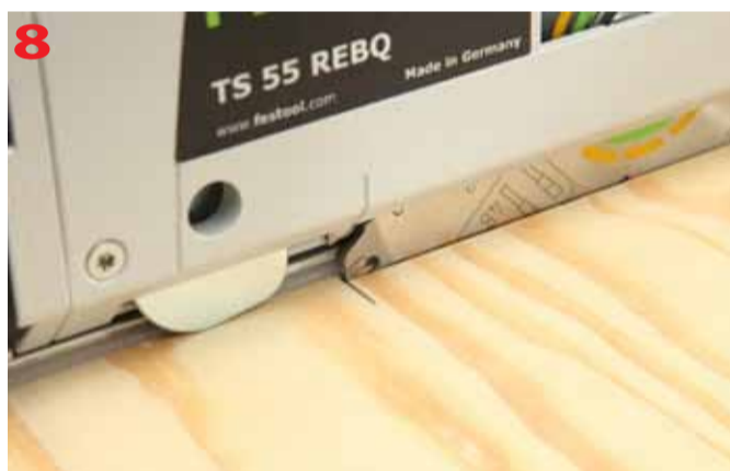
Po wykonaniu wcięcia zagłębiającego tarczę w materiał możemy skontrolować początek linii cięcia
