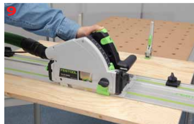
Pilarkę prowadzimy po szynie FS/2 do przedniego ogranicznika
