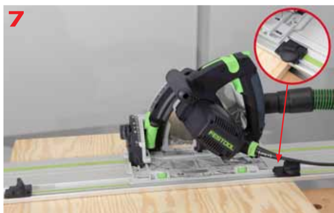
Po ustawieniu pilarki w odpowiedniej pozycji na szynie FS/2 blokujemy zabezpieczenie FS-RSP
