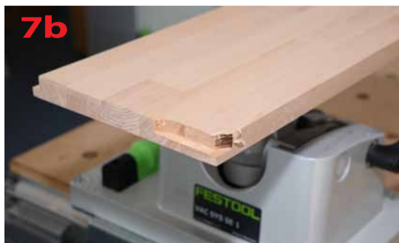
Frezowanie współbieżne podczas prowadzenia frezarki po materiale
