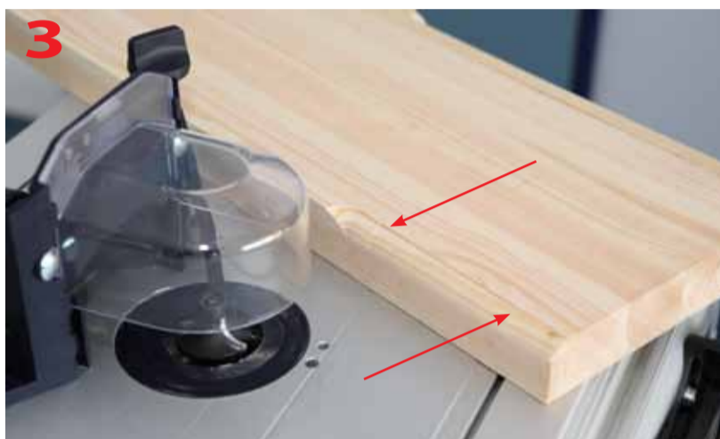
Widoczne niedofrezowania profilu będące efektem zbyt pospieszonego frezowania współbieżnego
