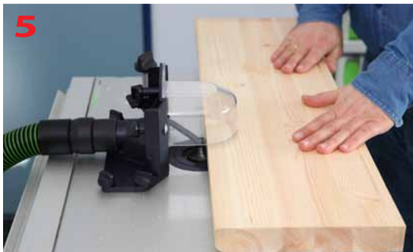
Praktyczne zastosowanie frezowania przeciwbieżnego
