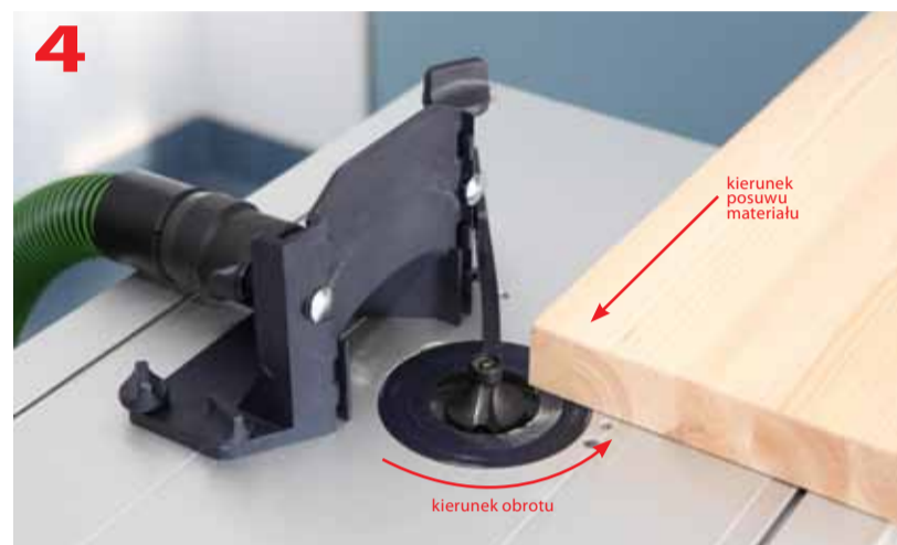
Zasada frezowania przeciwbieżnego
