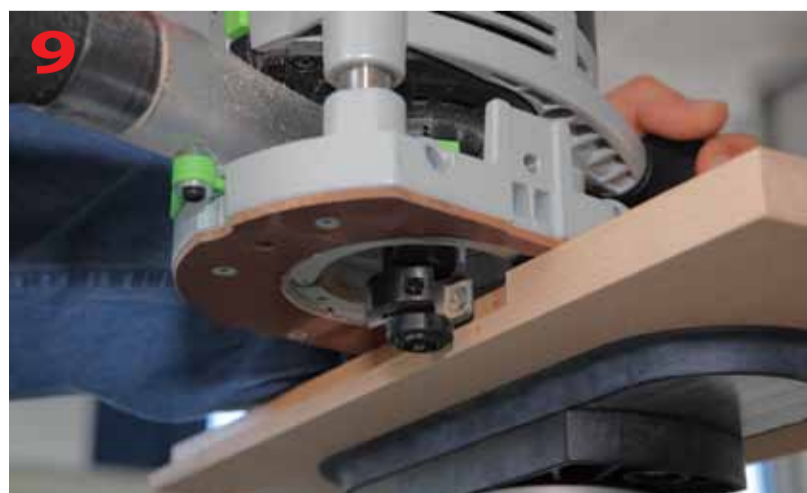
Praktyczne zastosowanie frezowania przeciwbieżnego
