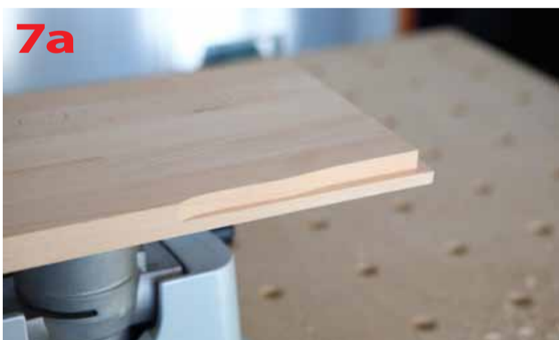
Przykładowe wady obróbki powstałe podczas frezowania współbieżnego
