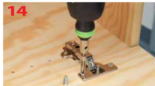
Odpowiednia budowa wiertła pozwala na jego prostopadle ustawienie względem płaszczyzny zawiasu
