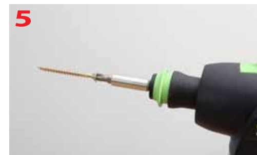
Wkręt utrzymuje osiowe położenie
