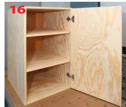
Dzięki zastosowaniu systemu CENTROTEC szafka została zmontowana dokładnie i w krótkim czasie
