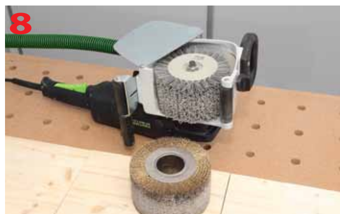
Szlifierka uzbrojona w szczotkę KB 80 przygotowana do fazy doglądania
