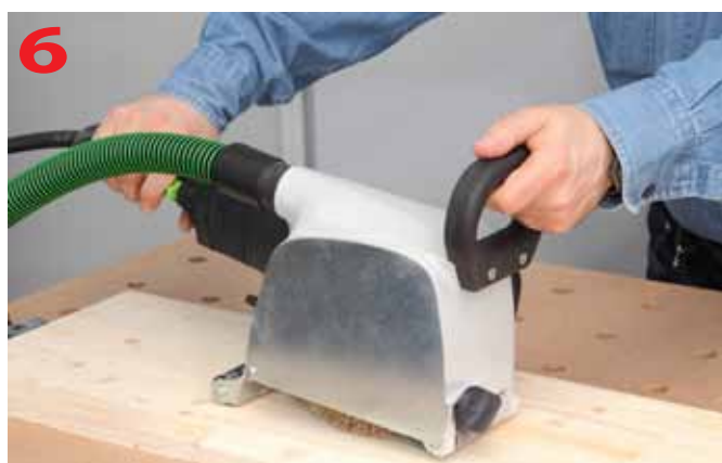
Prowadzenie szlifierki po materiale ruchem posuwisto-zwrotnym
