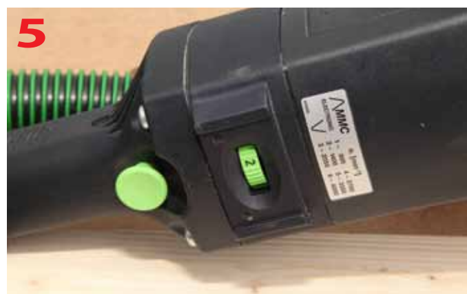
Ustawienie potencjometru regulacji obrotów maszyny
