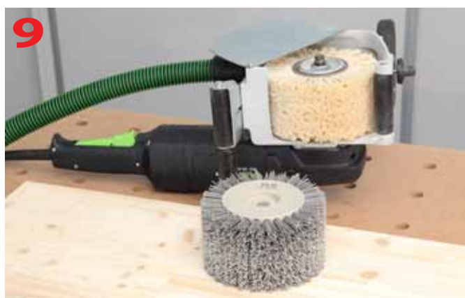
Szlifierka uzbrojona w szczotkę BG 85 przygotowana do fazy wykończenia powierzchni
