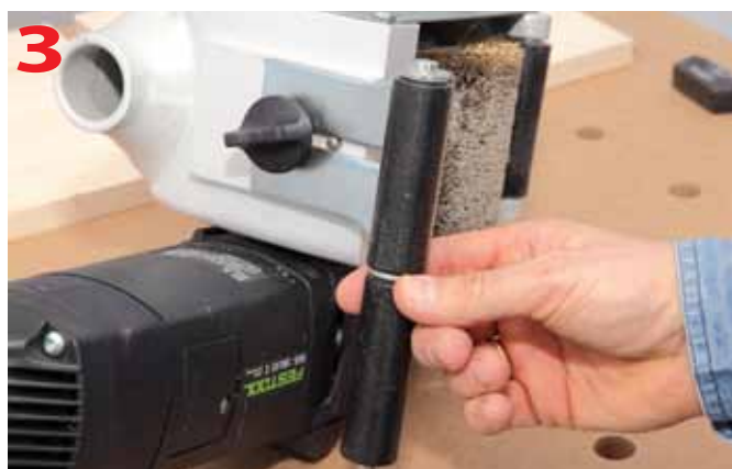
Regulacja tylnej rolki prowadzącej
