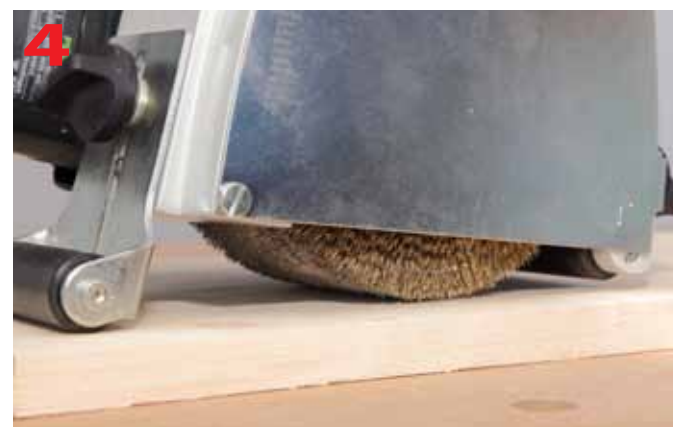
Prawidłowe ustawienie maksymalnego zagłębienia szczotki w materiale
