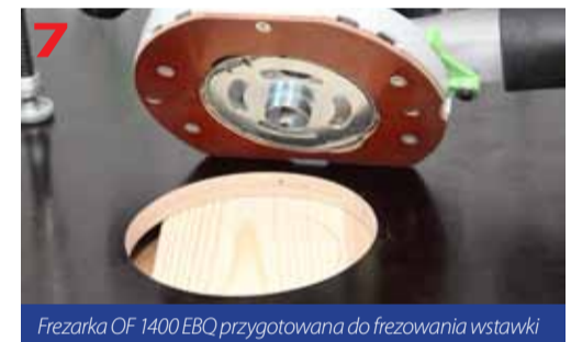
Po usunięciu fragmentu wadliwego dobieramy usłojenie wstawki
