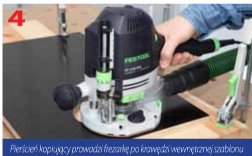
Frezowanie wykonujemy stopniowo w trzech przejściach
