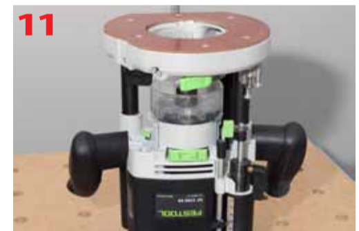
Frezarka OF 2200 EB z wyposażeniem potrzebnym do wykonania wstawki
