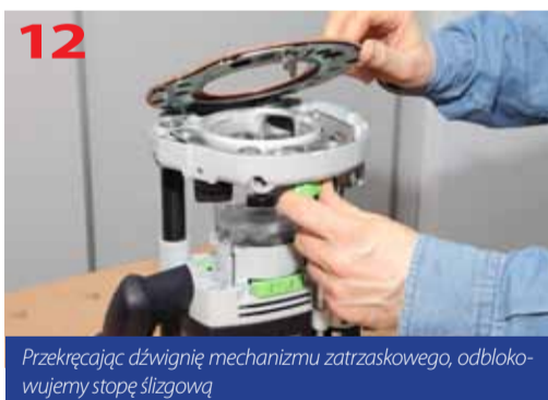
Przekręcając dźwignię mechanizmu zatraskowego, odblokowujemy stopę ślizgową
