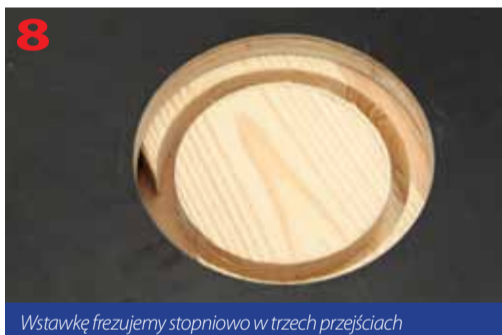
Wstawkę frezujemy stopniowo w trzech przejściach
