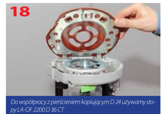
Montaż pierścienia kopiującego D 24 w stole frezarki OF 2200 EB
