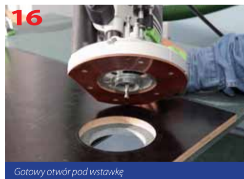
Pierścień kopiujący D 40 układamy na wewnętrznym namagnesowanym pierścieniu stołu frezarki korzystając z elementów pozycjonujących
