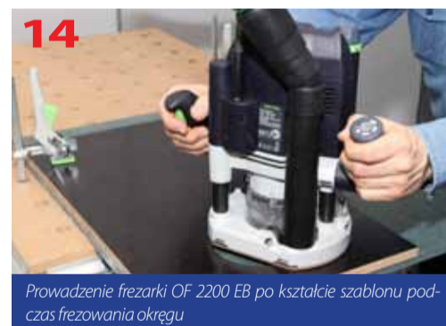
Prowadzenie frezarki OF 2200 EB po kształcie szablonu podczas frezowania okręgu
