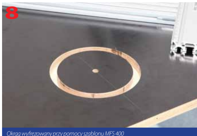
Okrąg wyfrezowany przy pomocy szablonu MFS 400
