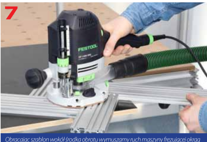
Obracając szablon wokół środka obrotu wymuszamy ruch maszyny frezującej okrąg
