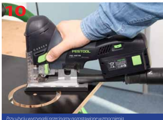
Przy użyciu wyrzynarki przecinamy pozostawione wzmocnienia
