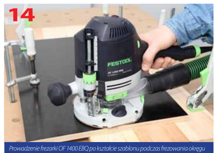
Po wyjęciu wewnętrznego okręgu wyrównujemy krawędzie dolnej części otworu.
