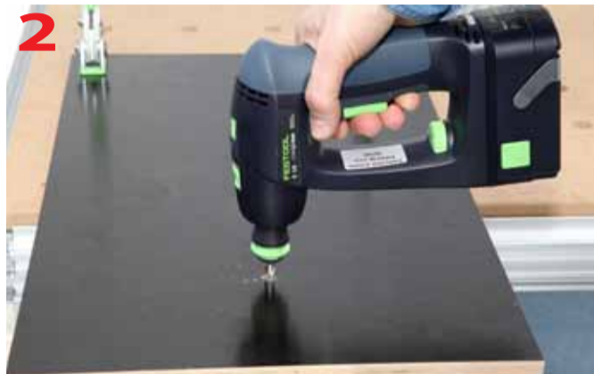
Środek obrotu szablonu wykonujemy wierząc w materiale otwór o średnicy 8 mm
