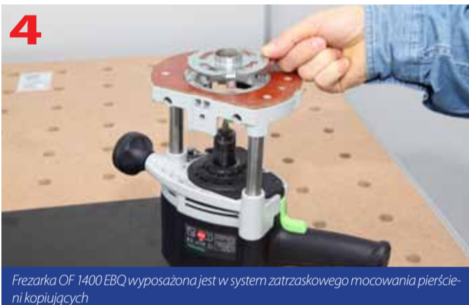
Dociskając pierścień kopiujący zatrzaskujemy elementy mocujące
