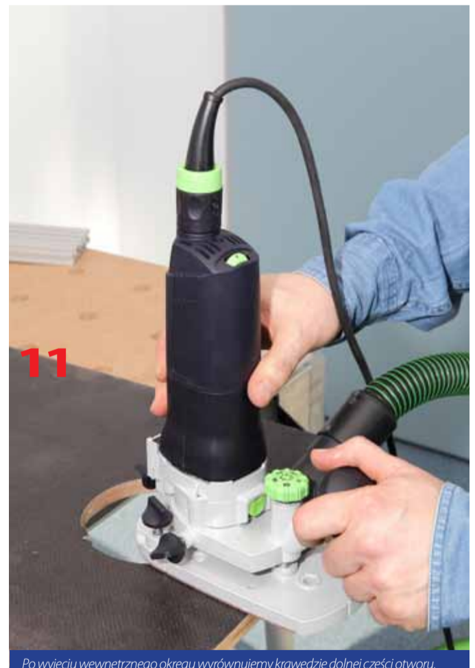
Po wyjęciu wewnętrznego okręgu wyrównujemy krawędzie dolnej części otworu.
