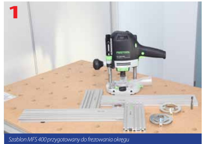
Szablon MFS 400 przygotowany do frezowania okręgu
