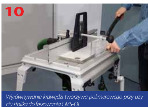
Frezowanie wręgi na krawędzi płyty tworzywa polimerowego
