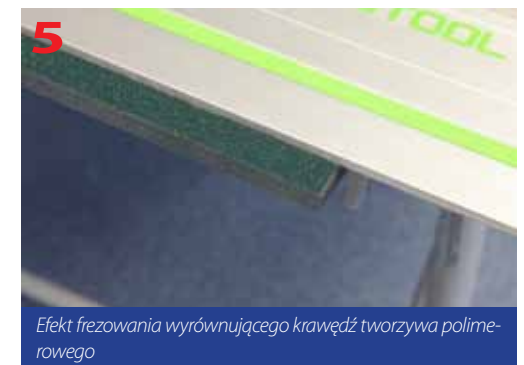
Wyrównywanie krawędzi przy użyciu frezarki OF 2200 EB z wykorzystaniem systemu prowadzącego FS
