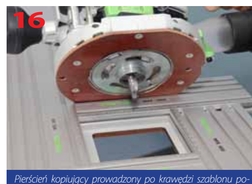
Frezowanie koła z wykorzystaniem szablonu kształtowego wykonanego ze sklejki
