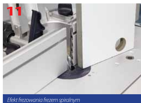
Wyrównywanie krawędzi tworzywa polimerowego przy użyciu stolika do frezowania CMS-OF
