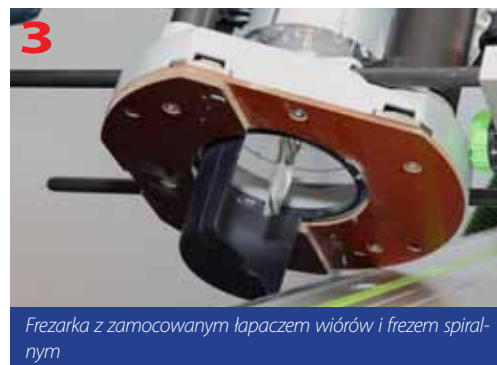
Zastosowaniu łapacza wiórów skutecznie poprawia ich odsysanie
