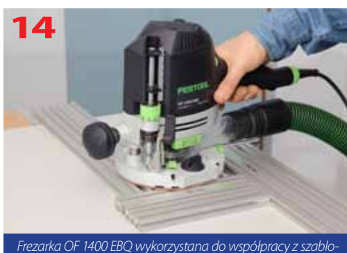
Wyrównywanie krawędzi tworzywa polimerowego przy użyciu stolika do frezowania CMS-OF
