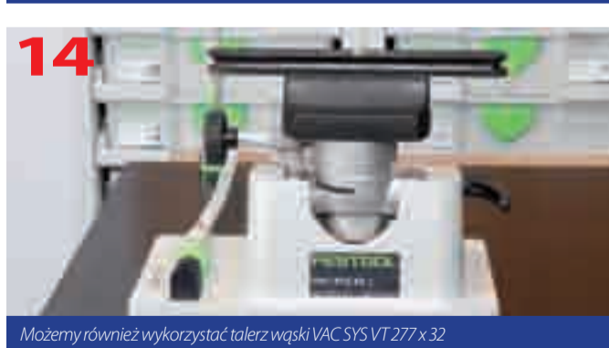
Talerz owalny wsuwamy osiowo w gniazdo mocowania i blokujemy trzpieniem
