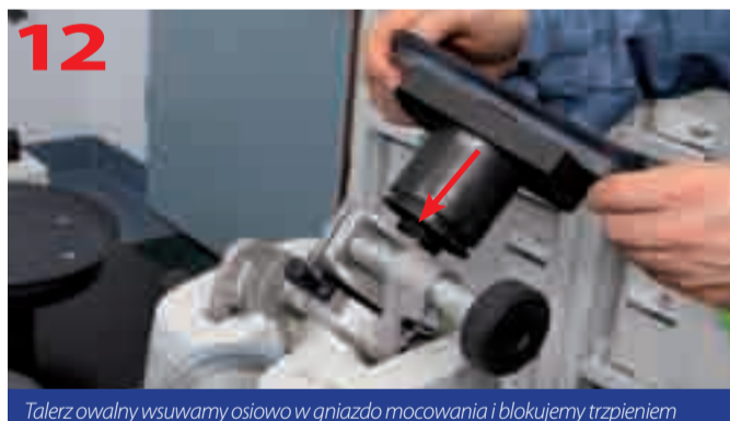
Talerz owalny wsuwamy osiowo w gniazdo mocowania i blokujemy trzpieniem
