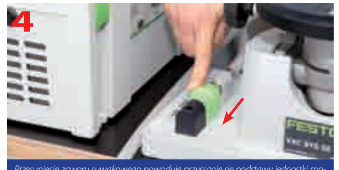
Przesunięcie zaworu suwakowego powoduje przysianie się podstawy jednostki mocującej do podłoża
