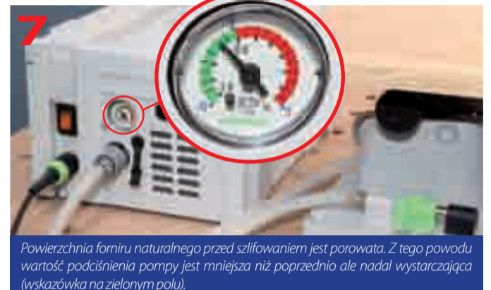
Przesunięcie zaworu suwakowego powoduje przysianie się podstawy jednostki mocującej do podłoża
