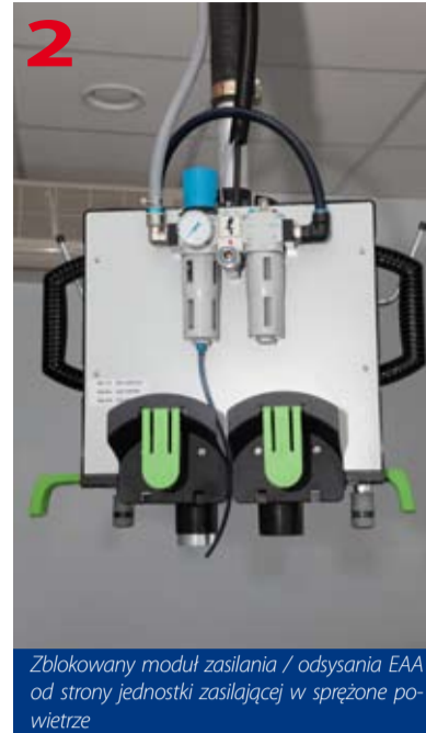
Wysięgnik odsysający ASA 2500 wyposażony w moduł zasilania/odsysania EAA w wersji EW/DW
