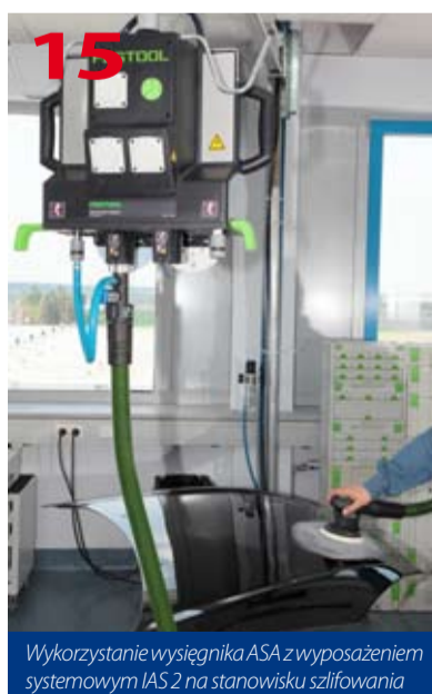
Wysięgnik ASA 2500 z wyposażeniem systemowym przygotowany do pracy
