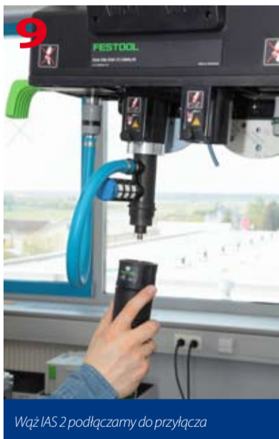
Do modułu wysięgnika podłączamy przewód sterujący automatycznym załączaniem odkurzacza
