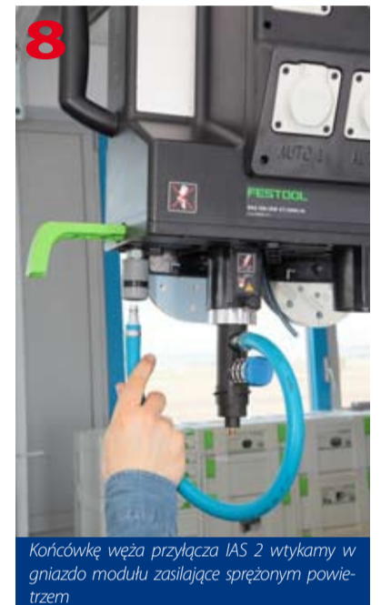
Moduł zasilania w sprężone powietrze należy wymienić na moduł sterujący wysięgnika EAA CT 26/36
