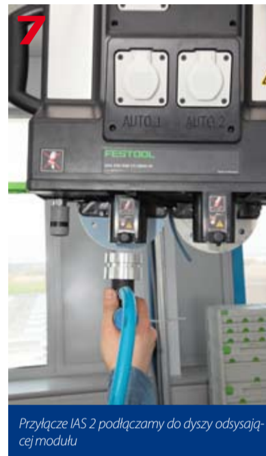
Zblokowany moduł zasilania / odsysania EAA od strony jednostki zasilającej w sprężone powietrze
