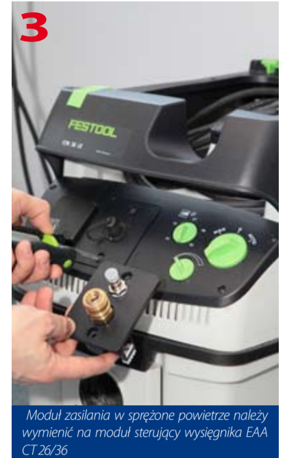
Zblokowany moduł zasilania / odsysania EAA od strony jednostki zasilającej w sprężone powietrze
