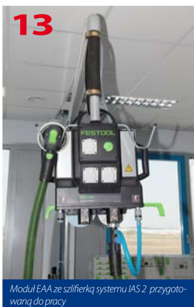
Wąż IAS 2 podłączamy do przyłącza
