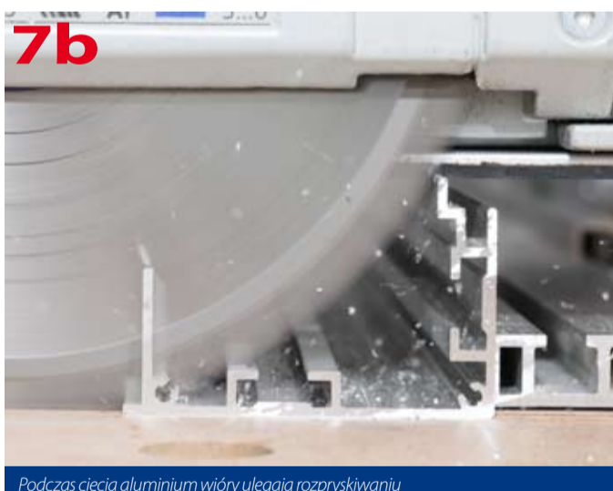
Podczas cięcia aluminium wióry ulegają rozpryskiwaniu
