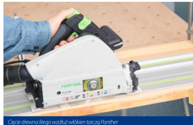
Cięcie drewna litego wzdłuż włókien tarczą Panther
