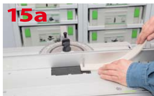
Wycinanie elementów giętych z tworzywa sztucznego przy przykładnicy kątowej
