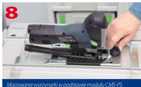
Mocowanie wyrzynarki w podstawie modułu CMS-PS
