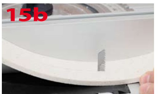
Wycinanie elementów giętych z tworzywa sztucznego przy przykładnicy kątowej
