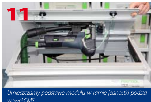
Umieszczamy podstawę modułu w ramie jednostki podstawowej CMS
