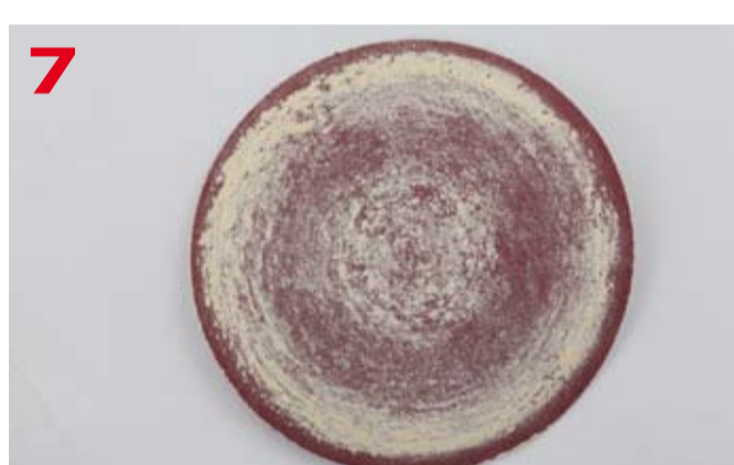
Zaszliczenie materiału ściernego P 150 przy szlifowaniu drewna żywicznego
