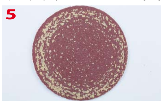
Szybkie zaszliczenie materiału ściernego P 50 spowodowane ustawieniem zbyt wysokiej prędkości obrotowej
