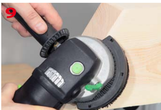
Skuteczne odsysanie pyłu przy fazowaniu krawędzi belki
