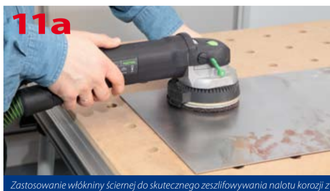
Szczelina odsysająca pył podczas szlifowania współpracuje z wkładem szczotkowym
